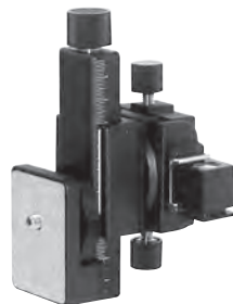
SFC マイクロ微動装置1WAY-L ネジ送り式1回転1mm 1軸：50mm 水平調整：±6° 回転：360°
