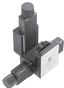
SFC マイクロ微動装置XY ネジ送り式1回転1mm 2軸：各50mm
