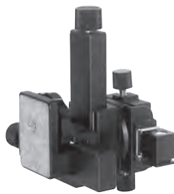
SFC マイクロ微動装置XY-L ネジ送り式1回転1mm 2軸：各50mm 水平調整：±6° 回転：360°
