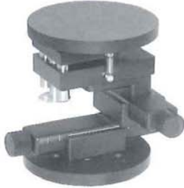
SFC XYZθステージ(台座付) 1回転4ミリ、ネジ送り式 耐荷重:4kg XY: ±25ミリ Z: ±3ミリ θ: 360°
