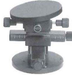
SFC 傾斜ステージXYθ(台座付) 1回転4ミリ、ネジ送り式 耐荷重:4kg XY: ±25ミリ θ: 360° 傾斜: ±6°
