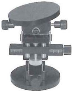
SFC 傾斜ステージXYZθ(台座付) 1回転4ミリ、ネジ送り式 耐荷重:4kg XY: ±25ミリ 1θ: 360° Z: ±3ミリ 傾斜: ±6°
