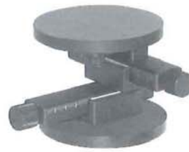
SFC XYθステージ(台座付) 1回転4ミリ、ネジ送り式 耐荷重:4kg XY: ±25ミリ θ: 360°
