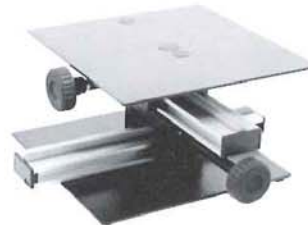
SFC XYテーブル200 ラックビニヨンによる±100ミリのテーブルです。大きくすばやく動かしたいものに最適です。鉄板ステージ。ステージサイズ:200×200ミリ 耐荷重:4kg
